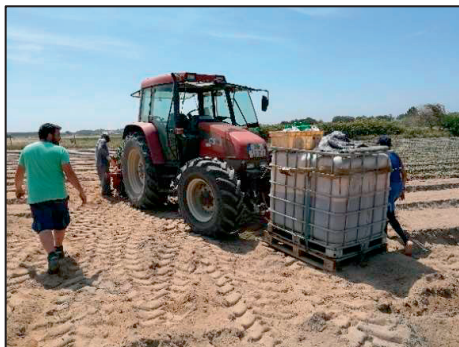
10. ábra. Traktor elejére szerelt IBC-tartály az ültetéssel egy időben megoldott öntözéshez (Portugália)
