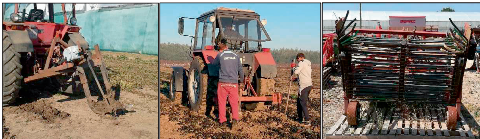
18. ábra. Batáta termés kiemelése rázóvillás soros kiemelőgéppel és csemete alávágóval, valamint módosított burgonya betakarító gép (balról jobbra)
