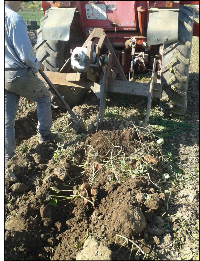
betakarítás rázóvillás soros kiemelőgéppel
