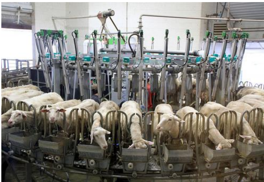
72. kép: Fejőház, karusszel elrendezés
